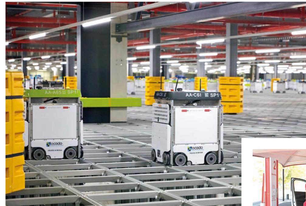
— Avec la solution Ocado en entrepôt, les robots sélectionnent les produits contenus dans les alvéoles de stockage, puis les acheminent jusqu'aux équipes qui préparent les commandes.
