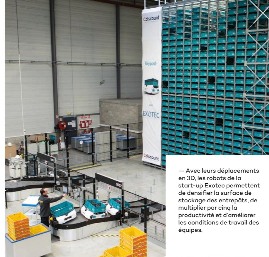
— Avec leurs déplacements en 3D, les robots de la start-up Exotec permettent de densifier la surface de stockage des entrepôts, de multiplier par cinq la productivité et d'améliorer les conditions de travail des équipes.
